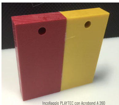
Incollaggio PLAYTEC con Acrobond A 260
